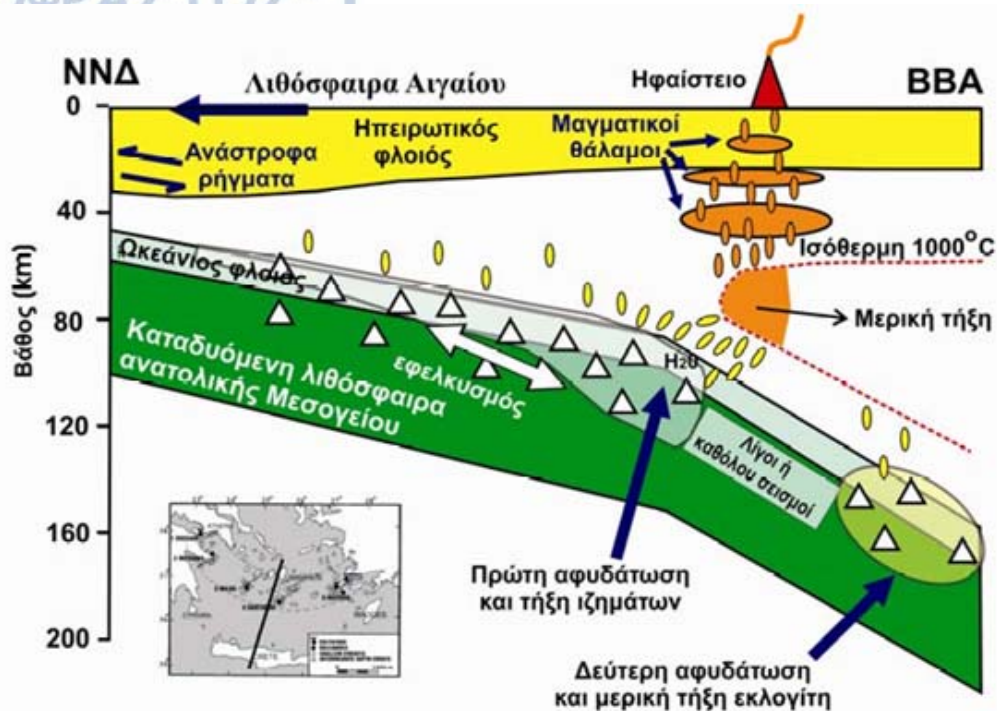
Σχήμα 1.8. Τομή NNΔ-BBA προτεινόμενου μοντέλου για τη γένεση των σεισμών ενδιάμεσου βάθους και της ηφαιστειακής δράσης στο νότιο Αιγαίο (Parazachos et al., 2005).
