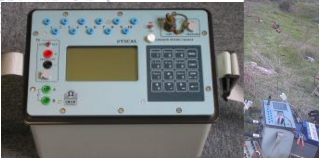
Σχήμα 2.5. Το γεωηλεκτρικό όργανο SYSCAL-Pro της εταιρείας IRIS INSTRUMENTS που χρησιμοποιήθηκε για τη λήψη των μετρήσεων. (αριστερά). Ο εξοπλισμός με τη συνδεσμολογία που χρησιμοποιήθηκε κατά τη διάρκεια της μέτρησης (δεξιά).
