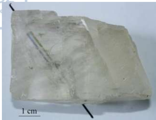
Εικόνα 71. Ο ασβεστίτης του δείγματος Sp17 από το βάραθρο του Όρλιακα. Διακρίνεται χαρακτηριστικά η διαύγεια και η διπλοθλαστικότητα του.
