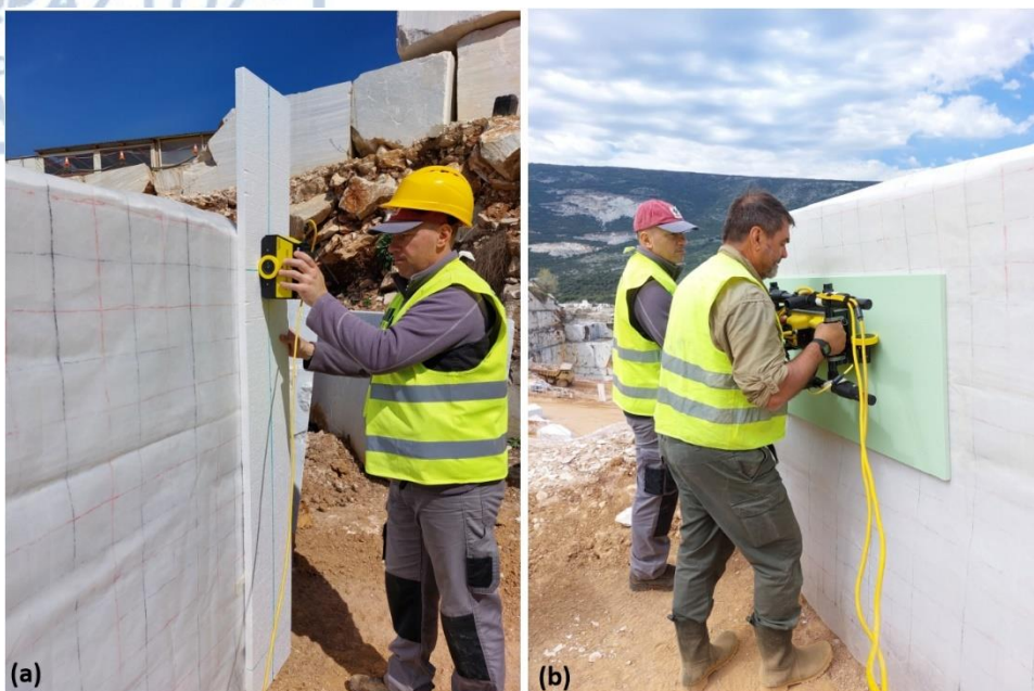
Εικόνα 29. Χρήση φελιζόλ κατά τη διάρκεια των μετρήσεων με δύο διαφορετικά συστήματα GPR, στο ρωγματομένο τέμαχος μαρμάρου «F». Αναλυτικότερα, απεικονίζονται (a) οι μετρήσεις με το σύστημα GPR TR1000, πάνω από φελιζόλ πάχους 2.5cm, (b) και οι μετρήσεις με το σύστημα GPR pulseEKKO PRO, κεντρικής συχνότητας 1000MHz, πάνω από φελιζόλ πάχους 2cm.
