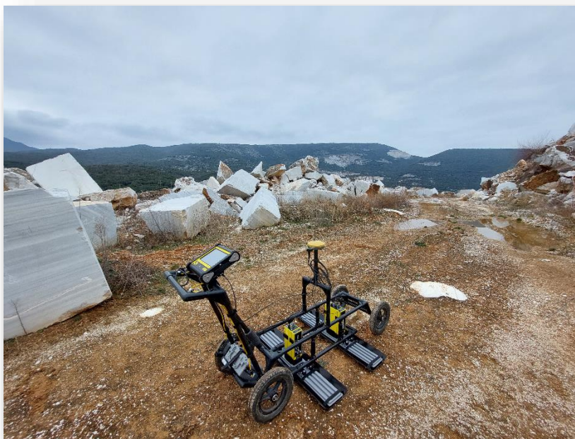
Εικόνα 9. Φωτογραφία του διστατικού συστήματος GPR pulseEKKO PRO Ultra Rx, κεντρικής συχνότητας 100MHz.
