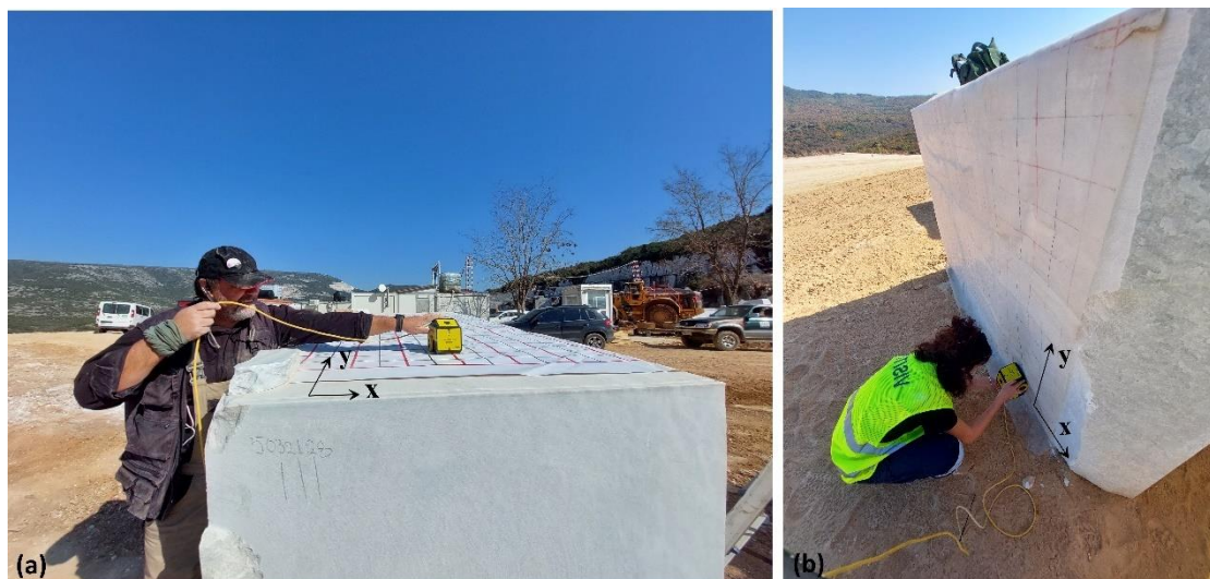
Εικόνα 25. Στις φωτογραφίες (a) και (b) απεικονίζεται το «πέτασμα» το οποίο χρησιμοποιήθηκε κατά τη διάρκεια των μετρήσεων τεμαχών μαρμάρου, με το σύστημα GPR TR1000.
