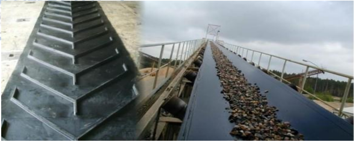
Σχήμα 2: Μεταφορά υλικών μέσω ταινιοφόρων για τις διαδοχικές φάσεις θραύσεων.
