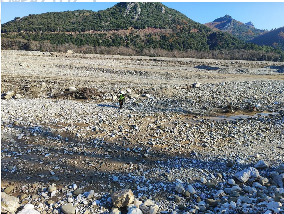
Σχήμα 63. Εικόνα από την κοίτη του ποταμού Πάμισου κατά τη διάρκεια αναμόχλευσης του δείγματος πριν τη συλλογή του.
