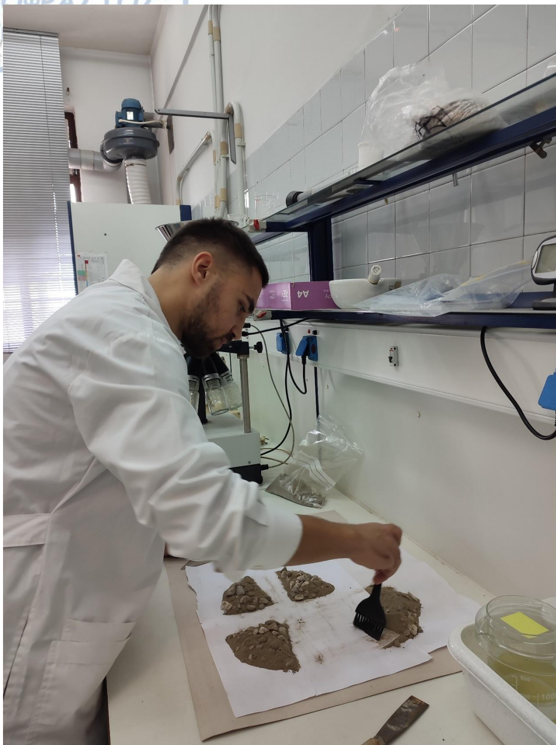
Σχήμα 66. Κατά τη διάρκεια εφαρμογής της μεθόδου του σταυρού για τυχαίο διαχωρισμό του δείγματος.
