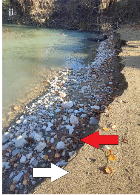
Σχήμα 44. Φωτογραφίες από τη Θ4.ι)Ακριβές σημείο δειγματοληψίας του PAM04 εντός της κοίτης του Πάμισου. ii)Ένα από τα σημεία που παρατηρείται η απότομη διαφοροποίηση του υλικού. Με άσπρο βέλος υποδεικνύεται το πιο λεπτόκοκκο ενώ με κόκκινο βέλος το πιο χονδρόκοκκο, σε άμεση επαφή με το προηγούμενο.
