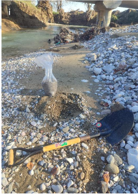
Σχήμα 44. Φωτογραφίες από τη Θ4.ι)Ακριβές σημείο δειγματοληψίας του PAM04 εντός της κοίτης του Πάμισου. ii)Ένα από τα σημεία που παρατηρείται η απότομη διαφοροποίηση του υλικού. Με άσπρο βέλος υποδεικνύεται το πιο λεπτόκοκκο ενώ με κόκκινο βέλος το πιο χονδρόκοκκο, σε άμεση επαφή με το προηγούμενο.
