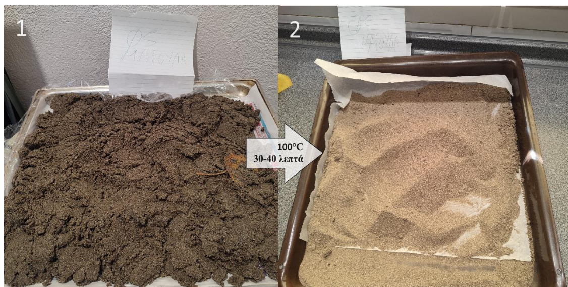
Σχήμα 31. Δείγμα PAM05 πριν (1) και μετά (2) από την εισαγωγή και παραμονή του στο φούρνο στους 100°C για περίπου 30-40 λεπτά.
