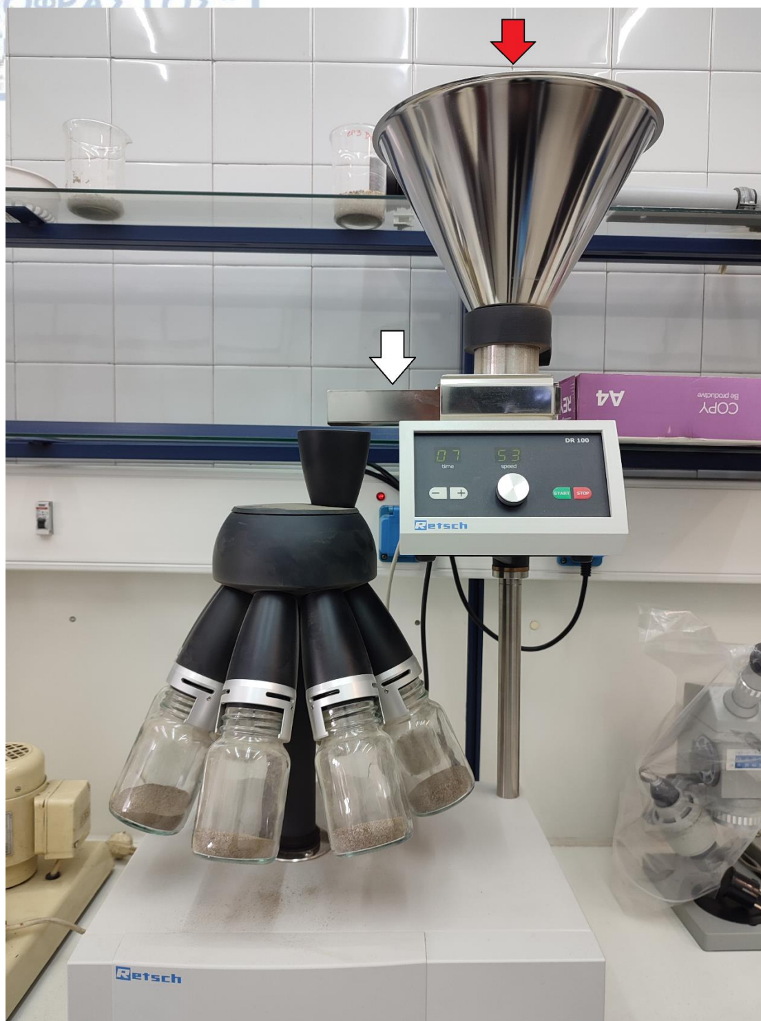
Σχήμα 33. Διαχωριστής Retsch PT100. Το κόκκινο βέλος υποδεικνύει το σημείο απ' όπου εισέρχεται το εκάστοτε δείγμα στο χωνί. Παράλληλα ο διαχωριστής ο οποίος ενώνεται με 8 γυάλινα δοχεία ξεκινάει να περιστρέφεται. Έπειτα το δείγμα, περνώντας από ένα μεταλλικό στενό διάδρομο (άσπρο βέλος) που πάλλεται με σκοπό το ανακάτεμα των κόκκων αλλά και την απόσπαση κολλημένων μεταξύ τους κομματιών, καταλήγει στον περιστρεφόμενο διαχωριστή. Η ταχύτητα με την οποία περιστρέφεται ο διαχωριστής, συνεπάγεται την τυχαιότητα του δείγματος που καταλήγει σε κάθε ένα από τα γυάλινα δοχεία, αφού είναι αρκετά μεγάλη για να καταφέρει κανείς να προβλέψει τη θέση που θα βρεθεί ο κάθε κόκκος. Έτσι εξασφαλίζεται πως στο τέλος της διαδικασίας, κάθε ένα από τα γυάλινα δοχεία θα περιέχει δείγμα αντιπροσωπευτικό του αρχικού όσον αφορά την κοκκομετρία, αλλά και το κυριότερο, ικανό ποσοτικά να μπει στα κόσκινα χωρίς να προκαλέσει πρόβλημα στο κοσκίνισμα. Σημειώνεται πως: α) εάν μετά τον διαχωρισμό, το δείγμα στα δοχεία εξακολουθεί να είναι ποσοτικά μεγάλο, ο διαχωρισμός με αυτή τη μέθοδο μπορεί να επαναληφθεί και β) εάν το δείγμα αποτελείται από κόκκους ικανούς να προκαλέσουν φθορές στο γυάλινα τοιχώματα των δοχείων τότε αποφεύγεται η χρήση του διαχωριστή και προτιμάται η μέθοδος του σταυρού.
