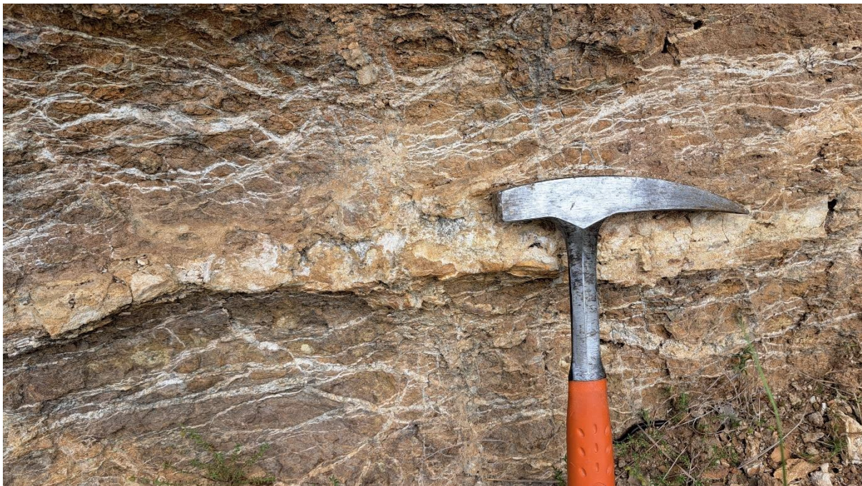
Σχ. 6.13. Πλέγμα λεπτών φλεβιδίων (stockwork) κυρίως μαγνησίτη μαζί με μικρές ποσότητες ασβεστίτη και χαλαζία (Προσωπικό αρχείο).
