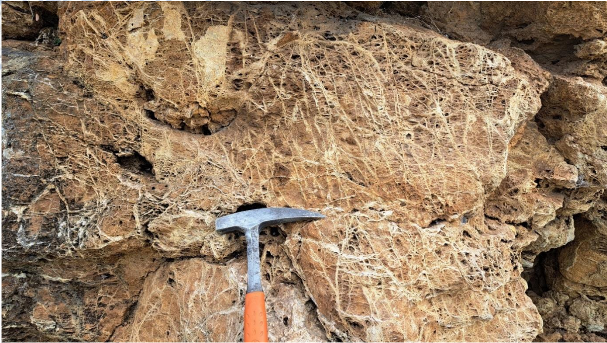
Σχ. 6.12. Πλέγμα φλεβιδίων (stockwork) κυρίως χαλαζία μέσα στον εξαλλοιωμένο δουνίτη. Διακρίνεται η πορώδης υφή (Προσωπικό αρχείο).
