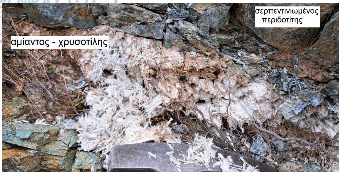
Σχ. 4.5. Cross fibre ίνες χρυσοτίλη μαζί με τάλκη, σε παλαιά θέση εκμετάλλευσης κοιτάσματος τάλκη και αμιάντου 2,5 χλμ. βόρεια του Πανοράματος, σύμφωνα με τον Σαπουντζής (1969) (Προσωπικό αρχείο).
