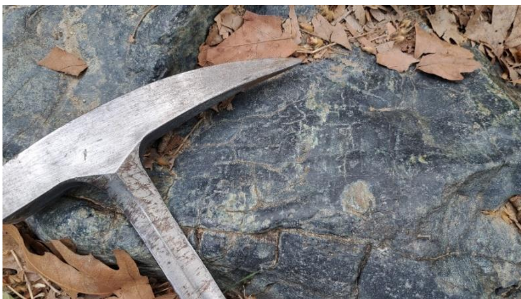
Σχ. 1.2. Μερικώς σερπεντινωμένος περιδοτίτης με χρώμα σκούρο πράσινο από το Πανόραμα Θεσσαλονίκης, θέση Πλατανάκια, 1,5 χλμ ΑΝΑ του Πανοράματος (Προσωπικό αρχείο).
