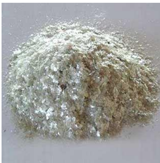
Εικόνα 0.2 Τυπική εικόνα τριμμάτων μαρμαρυγία ( flake mica ) (από Mica Flakes Powder – Pigments & Allieds )
