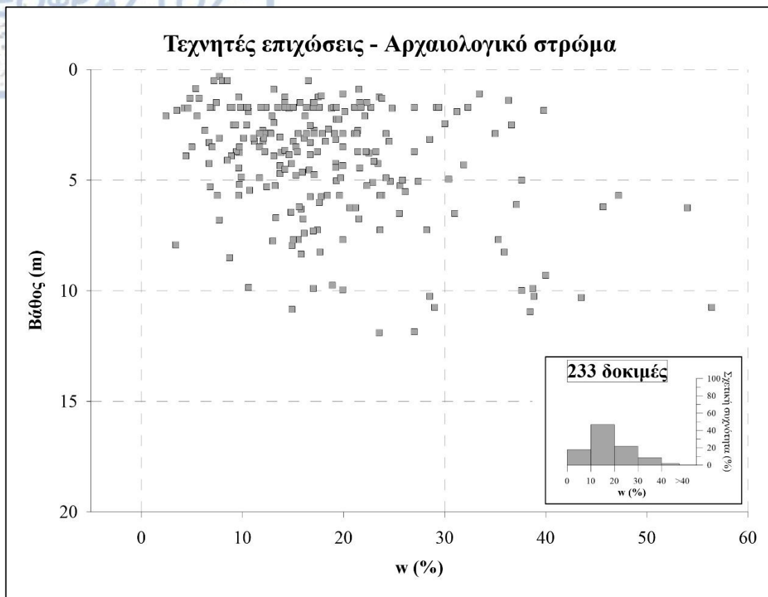
Σχήμα 6.19: Διάγραμμα κατανομής τιμών περιεχόμενης υγρασίας (w) για τις τεχνητές επιχώσεις
