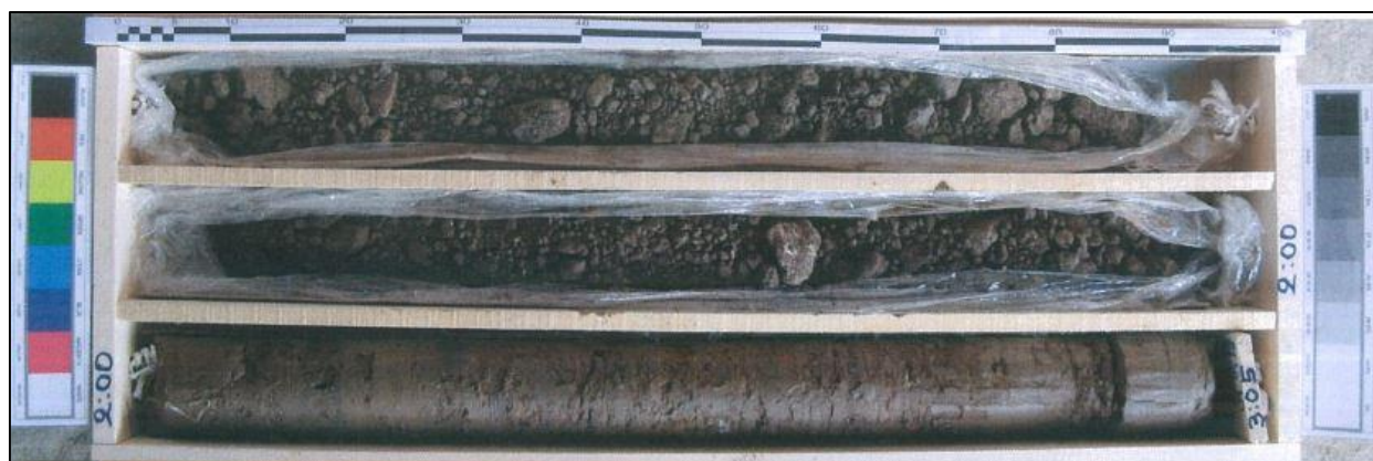
Σχήμα 6.2: Τεχνητές επιχώσεις, γεώτρηση στην περιοχή Αγίας Σοφίας. Περιγραφή: Χαλαροί έως μέτρια πυκνοί, λεπτόκοκκοι και αδρόκοκκοι, ιλυώδεις ΧΑΛΙΚΕΣ με άμμο έως ΧΑΛΙΚΕΣ κακής διαβάθμισης, λατύπες γνευσίου και θραύσματα από τούβλα, κεραμικά, χωρίς πλαστικότητα λεπτόκοκκο υλικό καστανού χρώματος (Αττικό Μετρό Α.Ε.)
