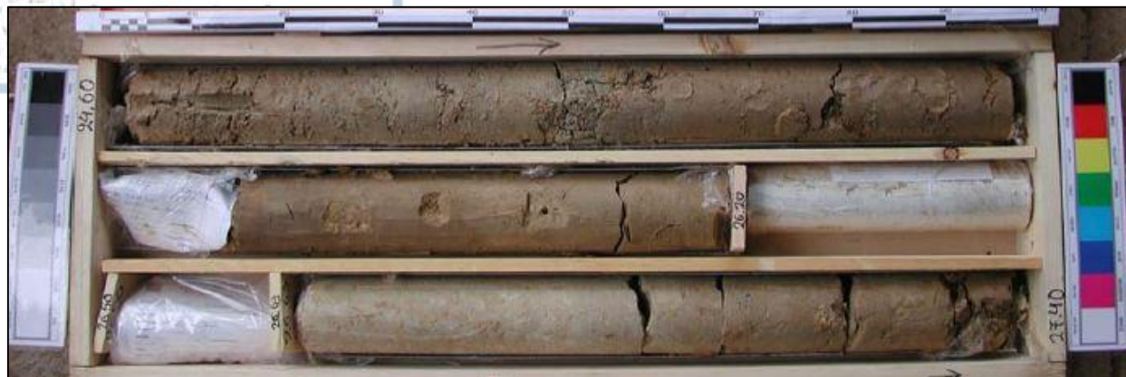
Σχήμα 6.7: Ψαμμιτομαργαϊκή σειρά Νεογενών αποθέσεων, γεώτρηση στην περιοχή Ευκλείδη. Περιγραφή: Πολύ στιφρή έως σκληρή, καστανοκίτρινη, ασβεστιτική ΑΡΓΙΛΟΣ. Κοκκομετρικά χαρακτηρίζεται ως παχιά-ισχνή ΑΡΓΙΛΟΣ με άμμο, μεγάλης έως μέσης πλαστικότητας έως τοπικά αργιλώδεις ΧΑΛΙΚΕΣ με άμμο μεγάλης πλαστικότητας. Από τα 26.63 m παρατηρείται ασθενής, καστανοκίτρινος, ΨΑΜΜΙΤΗΣ (Αττικό Μετρό Α.Ε.)
