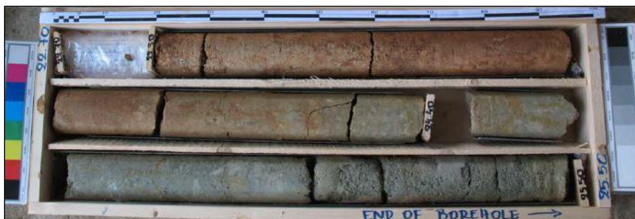
Σχήμα 6.9: Ψαμμιτομαργαϊκή σειρά Νεογενών αποθέσεων, γεώτρηση στην περιοχή Νέα Ελβετία. Περιγραφή: Πολύ ασθενής έως ασθενής, ανοικτός καστανοκόκκινος ΑΡΓΙΛΟΛΙΘΟΣ με ανθρακικά συσσωματώματα. Από τα 24.4 m παρατηρείται ασθενής ανοικτός πρασινωπός ΙΛΥΟΛΙΘΟΣ (Αττικό Μετρό Α.Ε.)
