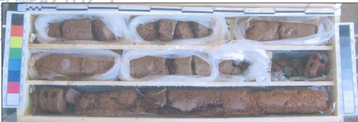
Σχήμα 6.1: Τεχνητές επιχώσεις, γεώτρηση στην περιοχή Συντριβάνι. Περιγραφή: ΑΜΜΟΣ με τούβλα, φυτικά και κροκάλες πρασινοσχιστολιθικής και χαλαζιακής προέλευσης (Αττικό Μετρό Α.Ε.)
