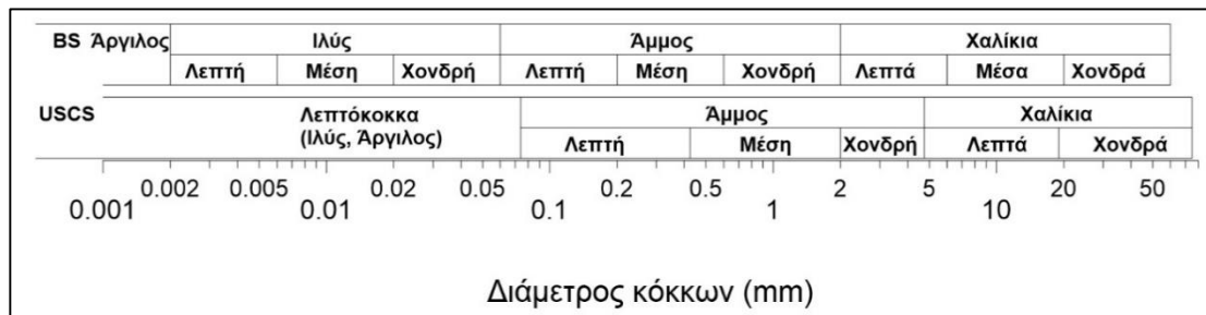
Σχήμα 4.29: Διάγραμμα αθροιστικής συχνότητας εμφάνισης ως προς το μέγεθος των κόκκων (σε λογαριθμική κλίμακα), σύμφωνα με τις ταξινομήσεις κατά USCS και BS
