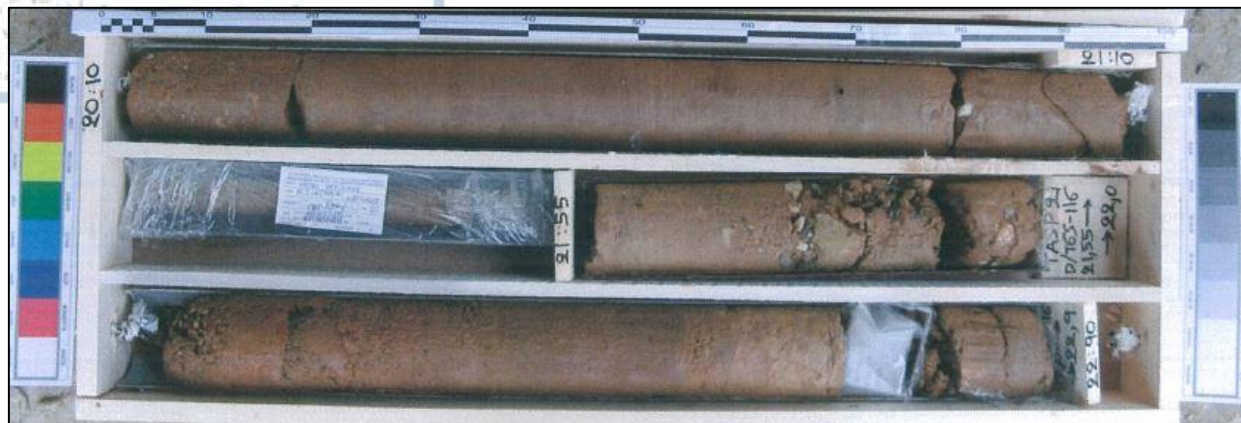
Σχήμα 6.10: Ερυθρές άργιλοι Νεογενών αποθέσεων, γεώτρηση στην περιοχή του Νέου Σιδηροδρομικού Σταθμού. Περιγραφή: Στιφρή έως πολύ στιφρή, ανοικτή καστανέρυθη έως καστανέρυθη, αμμώδης ΙΣΧΝΗ ΑΡΓΙΛΟΣ, με διάσπαρτους γωνιώδεις χάλικες σχιστολιθικής και χαλαζιακής προέλευσης (Αττικό Μετρό Α.Ε.)
