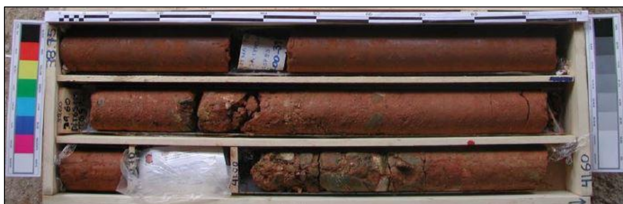
Σχήμα 6.12: Ερυθρές άργιλοι Νεογενών αποθέσεων, γεώτρηση στην περιοχή Πανεπιστήμιο. Περιγραφή: Πολύ στιφρή έως σκληρή, κόκκινη, αμμώδης ισχνή ΑΡΓΙΛΟΣ έως ισχνή ΑΡΓΙΛΟΣ με άμμο, μικρής έως μέσης πλαστικότητας, με λίγα λεπτά χαλίκια κατά τόπους. Από τα 39.7 m παρατηρείται πολύ ασθενές, κόκκινο, ΛΑΤΥΠΟΠΑΓΕΣ (Αττικό Μετρό Α.Ε.)
