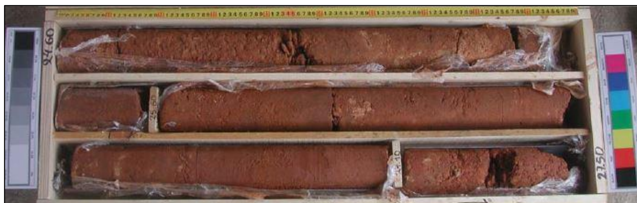
Σχήμα 6.11: Ερυθρές άργιλοι Νεογενών αποθέσεων, γεώτρηση στην περιοχή Αγίας Σοφίας. Περιγραφή: Πολύ στιφρή έως σκληρή, καστανοκόκκινη, ισχνή άργιλος με άμμο έως αμμώδης ισχνή άργιλος, μέσης πλαστικότητας με λίγα λεπτά χαλίκια κατά τόπους. Παρουσία ασβεστιτικών συγκριμάτων και οξειδίων Μαγγανίου (Mn). (Αττικό Μετρό Α.Ε.)
