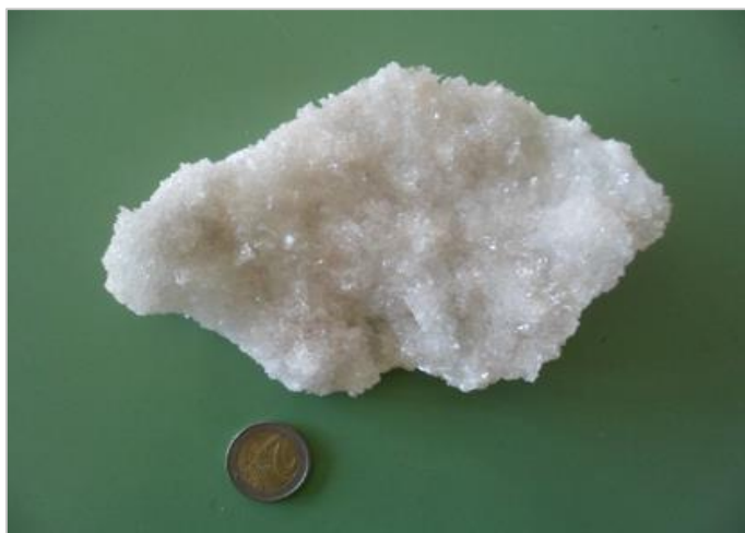
EIKONA 57: Γύψος. Λόγω της γυαλιστερής επιφάνειας αντανακλούσε τη δέσμη φωτός και δεν ήταν δυνατή η σάρωση του με τη χρήση structure light sensor. (Προσωπικό αρχείο Z.Πανταζοπούλου)
