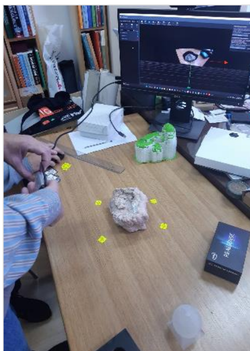
ΕΙΚΟΝΑ 38: Κατά την διάρκεια της σάρωσης του ορυκτού Ροδοχρωσίτη με τη χρήση LiDAR Camera L515 και στην οθόνη του υπολογιστή φαίνεται το περιβάλλον του λογισμικού Intel Real Sense Viewer™. Η σάρωση και η επεξεργασία πραγματοποιήθηκε από το Τμήμα Αγρ. Τοπογράφων Μηχ. του ΑΠΘ. (Προσωπικό αρχείο Ζ.Πανταζοπούλου)
