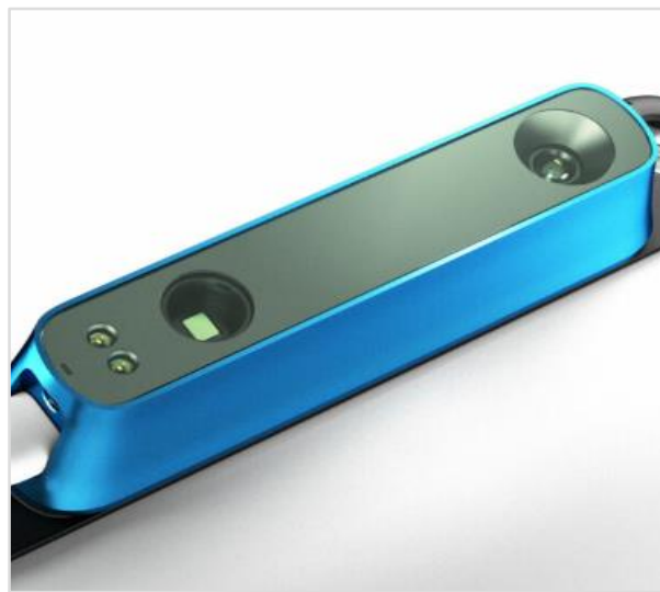
EIKONA 33: Ο αισθητήρας φωτός δομής (structure light sensor)
