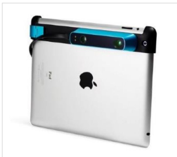
EIKONA 34: Ο αισθητήρας φωτός δομής (structure light sensor) ενσωματωμένος σε iPad (URL 24).
