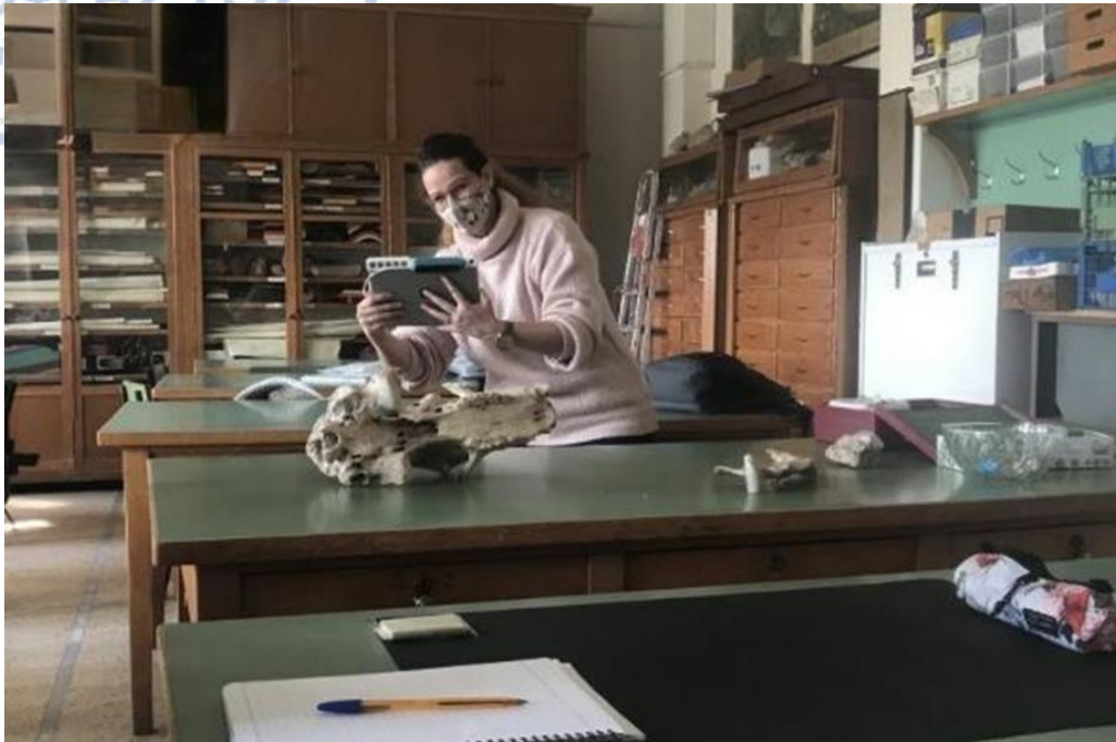
ΕΙΚΟΝΑ 35: Κατά την διάρκεια της σάρωσης του απολιθώματος με τη χρήση του αισθητήρα φωτός δομής (structure light sensor), ενσωματωμένο σε iPad. (Προσωπικό αρχείο Ζ.Πανταζοπούλου)
