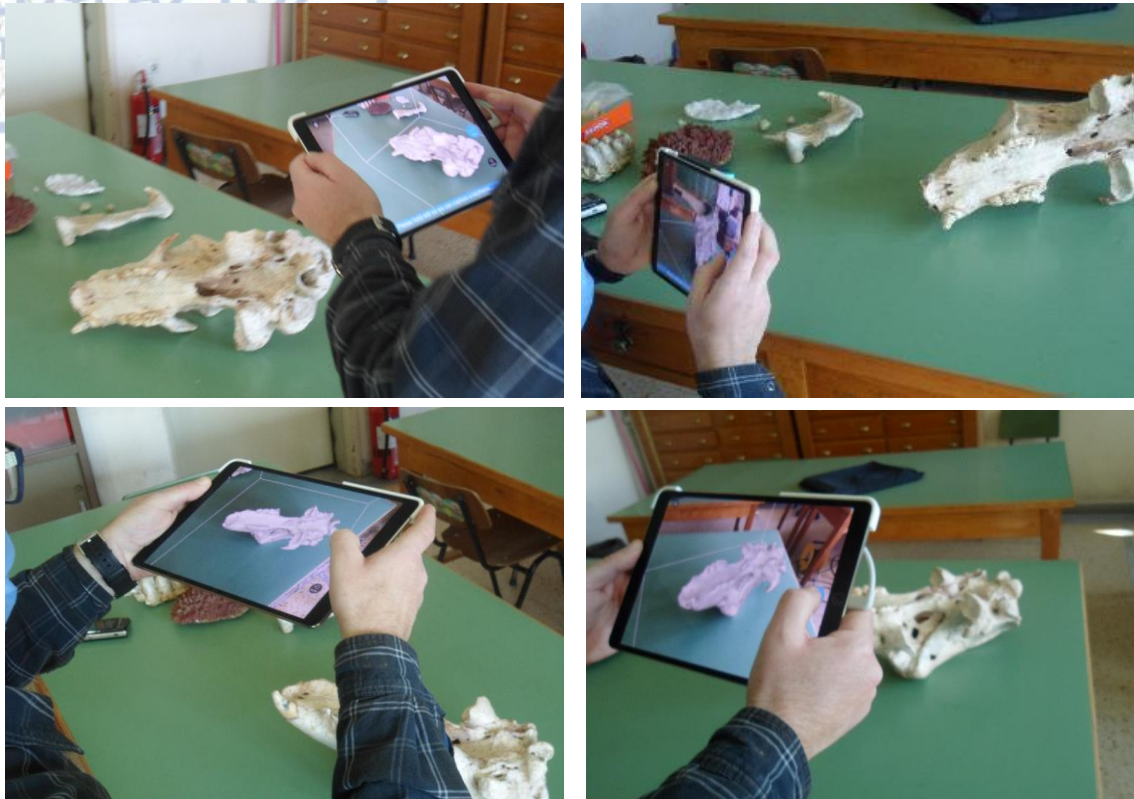
ΕΙΚΟΝΑ 36: Στιγμιότυπα από τη διαδικασία της σάρωσης του απολιθώματος του κρανίου της αρκούδας των σπηλαίων, με τη χρήση του αισθητήρα φωτός δομής (structure light sensor) ενσωματωμένος σε iPad. (Προσωπικό αρχείο Ζ.Πανταζοπούλου)
