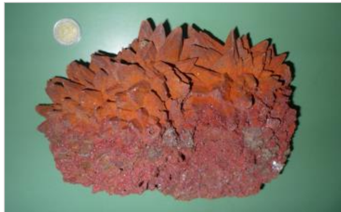
ΕΙΚΟΝΑ 59: Κρύσταλλος ασβεστίτη με λεπτόκοκκο αιματίτη. Λόγω της γεωμετρίας του με τις έντονες απολήξεις δεν ήταν δυνατή η σάρωση του με τη χρήση structure light sensor. (Προσωπικό αρχείο Ζ.Πανταζοπούλου)
