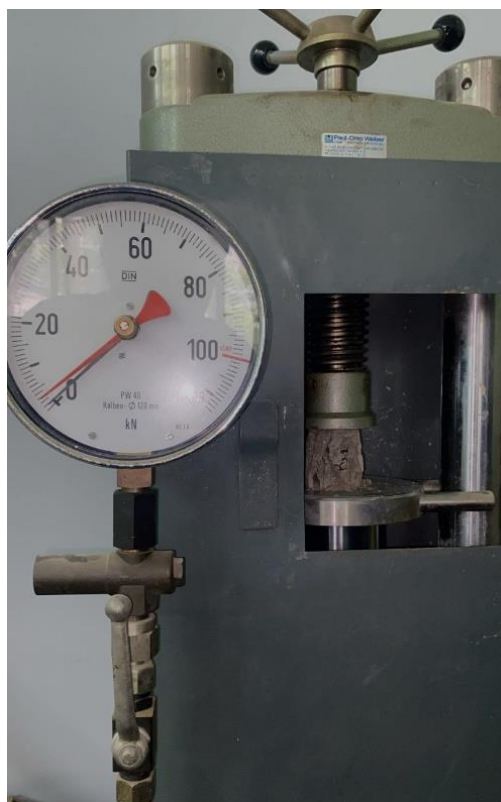
Εικόνα 9. Υδραυλική πρέσα του εργαστηρίου Τεχνικής Γεωλογίας & Υδρογεωλογίας.
