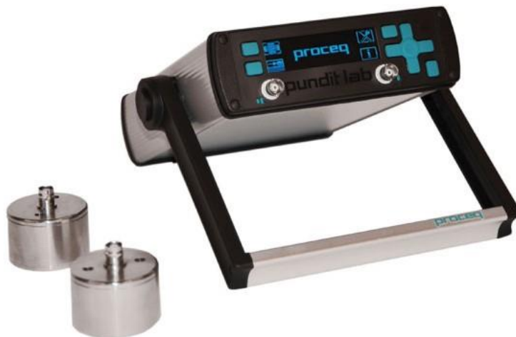
Εικόνα 7. Συσκευή PUNDIT LAB για τη μέτρηση της ταχύτητας των P-κυμάτων.
