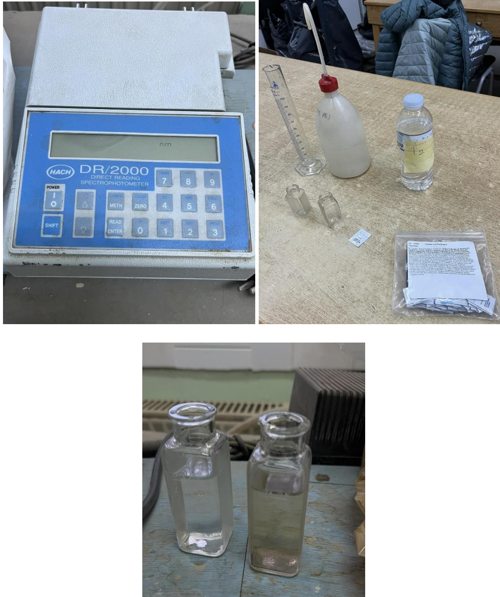
Σχήμα 4.4. Δοκιμή με τη χρήση φασματοφωτόμετρου HACH DR 2000.
