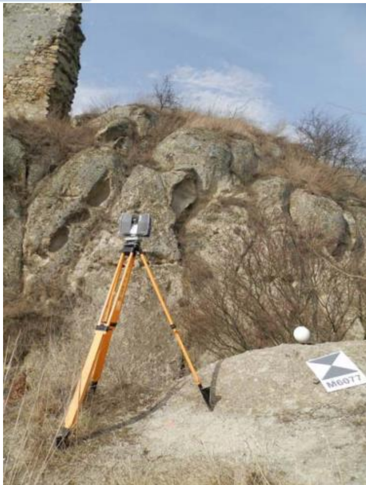
Εικόνα 3 Ένας επίγειος σαρωτής LiDAR (Török et al. 2016;Kordić et al. 2019)
