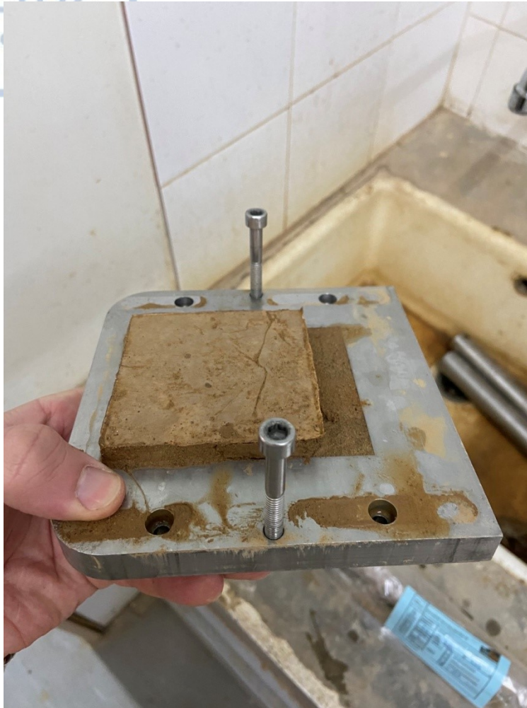
Εικόνα 20. Εδαφικό δείγμα μετά από δοκιμή άμεσης διάτμησης.
