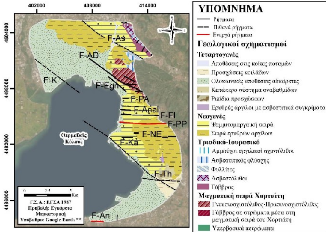
Εικόνα 9. Ψηφιοποιημένος γεωλογικός χάρτης της περιοχής έρευνας κλίμακα: 1:50.000, όπου: F-An ρήγμα Ανθεμούντα, F-Th ρήγμα Θέρμης, F-Ka ρήγμα Καλαμαριάς, F-NE ρήγμα Νέας Ελβετίας, F-PP ρήγμα Πυλαίας-Πανοράματος, F-FI ρήγμα Φλέμινγκ, F-Anal ρήγμα Ανάληψης, F-PA ρήγμα Πεδίου Άρεως, F-Egn ρήγμα Εγνατίας, F-AD ρήγμα Αγ. Δημητρίου, F-As ρήγμα Ασβεστοχωρίου, F-K ρήγμα Καλοχωρίου (τροποποιημένος από Kockel et al. 1978a, 1978b; Ζερβοπούλου, 2010)
