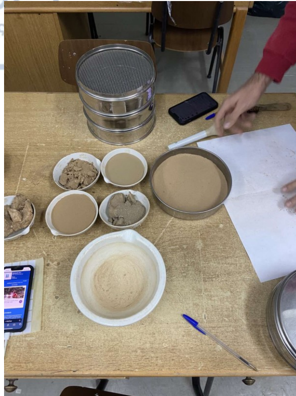
Εικόνα 15. Ταξινόμηση εδαφικού δείγματος με την μέθοδο των κόσκινων
