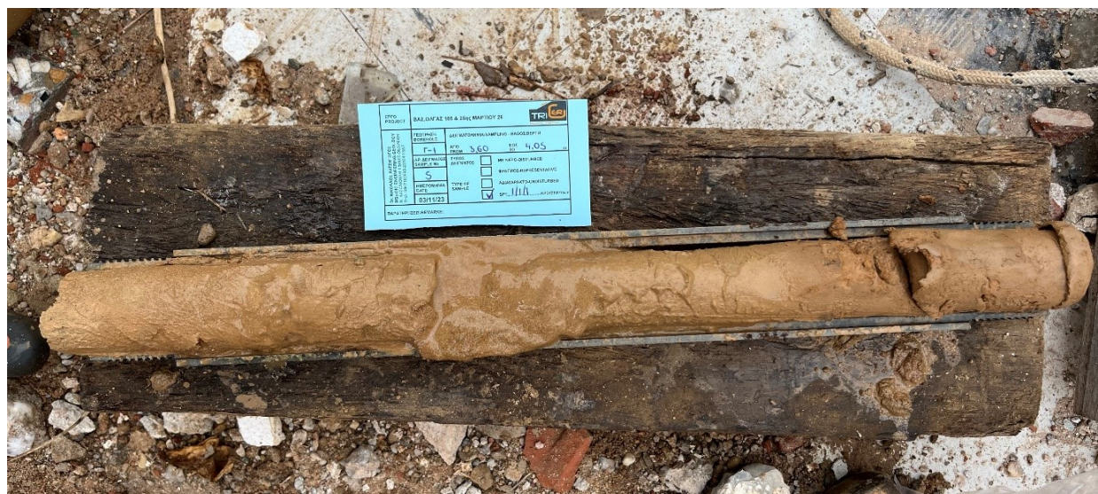
Εικόνα 14. Δείγμα γεώτρησης από δειγματολήπτη τύπου Terzaghi.
