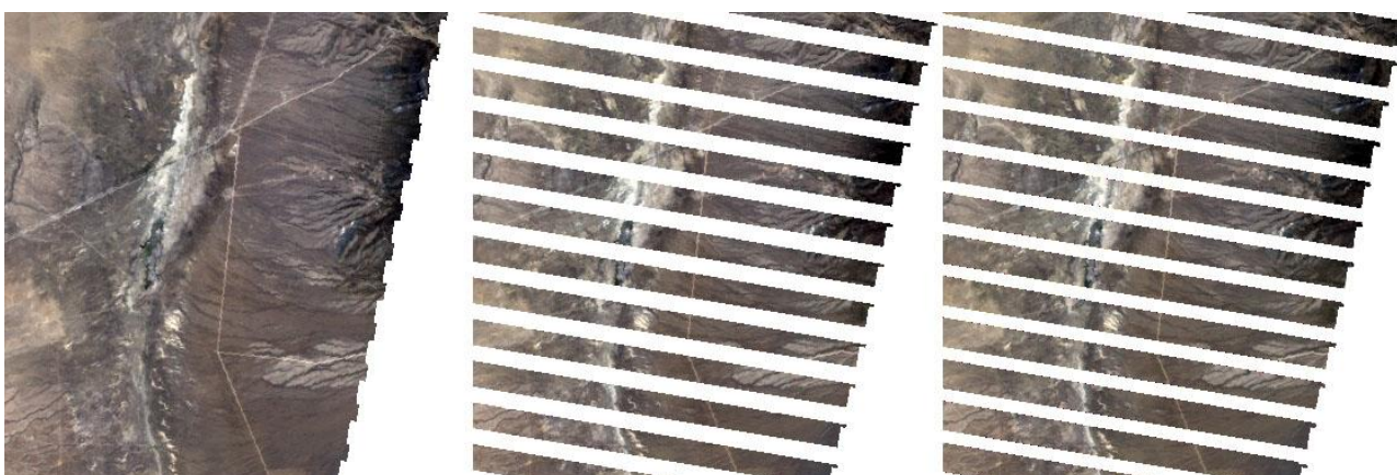
Σχήμα 2. Από αριστερά προς τα δεξιά. Εικόνα από παλαιότερη λήψη όταν δούλευε το σύστημα SLC. Πρόκειται για περιοχή στην άκρη της εικόνας. Η εικόνα μετά τη δυσλειτουργία του συστήματος. Στα δεξιά η εικόνα μετά τη γραμμική παρεμβολή (USGS et al., 2003).
