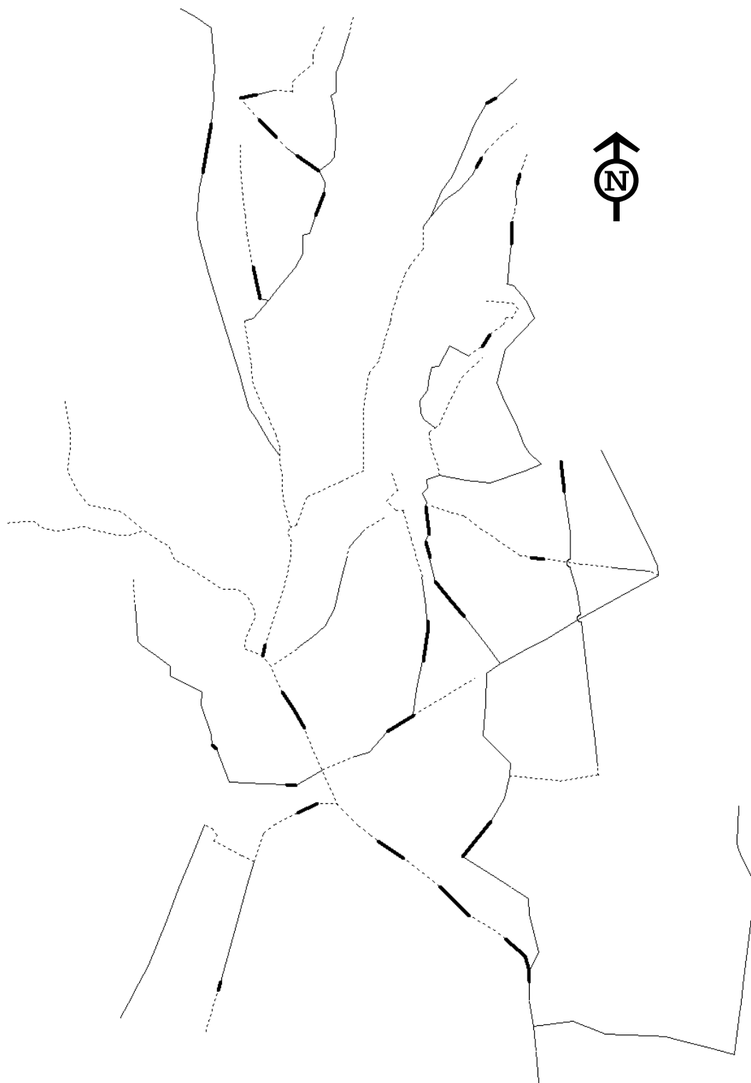
Σχήμα 4. Κεντρικοί συλλεκτήριοι αγωγοί εσωτερικού δικτύου αποχέτευσης ομβρίων υδάτων πόλης Κοζάνης. Εντοπισμός προβλημάτων πενταετίας και δεκαετίας.
