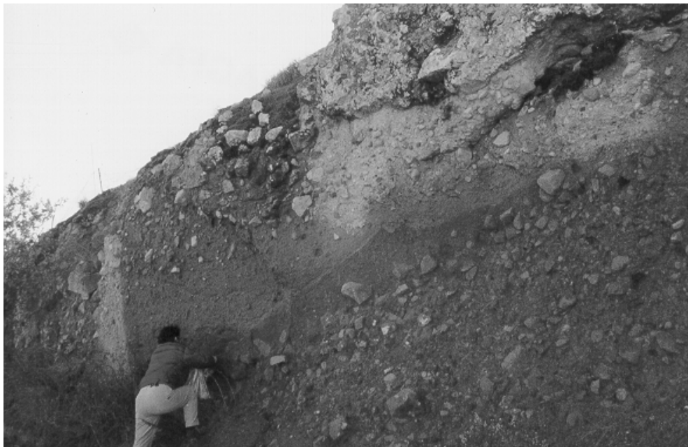
Σχ.3: Περιστροφική ολίσθηση. Στην εικόνα διακρίνεται το επίπεδο ολίσθησης. Fig.3: Slump. The sliding plane is distinguished.
