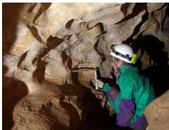
Εικόνα 6. Μέτρηση χαρακτηριστικών στροβιλοειδών γλυφών στο "Μικρό"Σπήλαιο Επαμύλων
