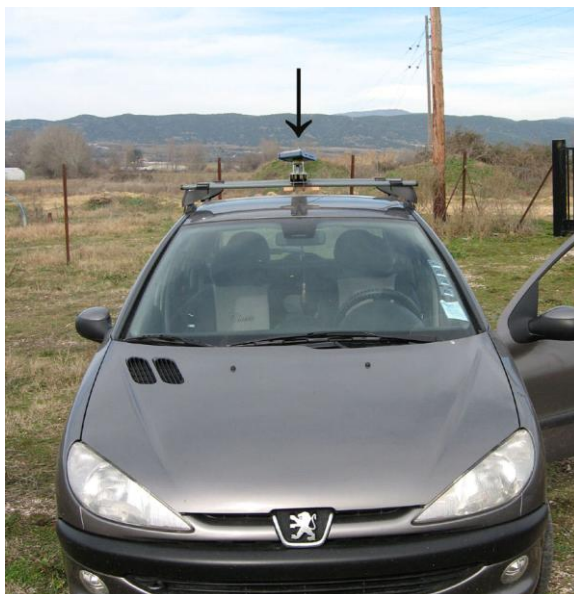
Σχήμα 3. Τοποθέτηση του κινητού δέκτη (rover) GNSS στο όχημα, το οποίο χρησιμοποιήθηκε για τις μετρήσεις.
