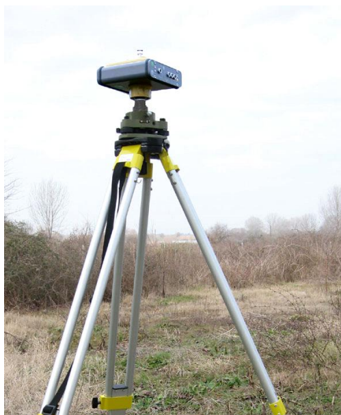
Σχήμα 2. Τοποθέτηση του σταθμού αναφοράς (βάσης/base) GNSS.
