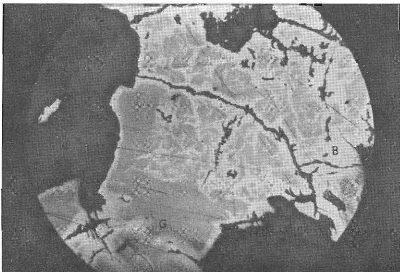
Fig. 2. Substitution de bornite G par de la chalcosine B allant de la périphérie, vers l'intérieur. On voit au centre la formation d'îlots et de veinules Nicols //  $\times 380$
