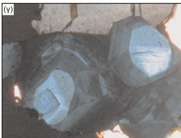
Σχήμα 2. Μικροφωτογραφίες από πολωτικό μικροσκόπιο ζωνωδών κρυστάλλων τουρμαλίνη της Νάξου. 30X, Παράλληλα Nicols. α) Κρύσταλλος τουρμαλίνη με δύο διακριτές συγκεντρικές ζώνες, β) Κρύσταλλος τουρμαλίνη (κάτω) με τρεις ζώνες ανάπτυξης, γ) Κρύσταλλοι τουρμαλίνη με πολλές ζώνες ανάπτυξης.
